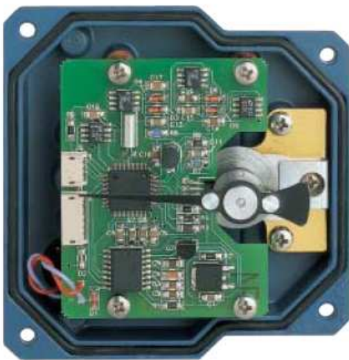
ADT-15 Caja indicadora + Transmisor 4-20 mA
