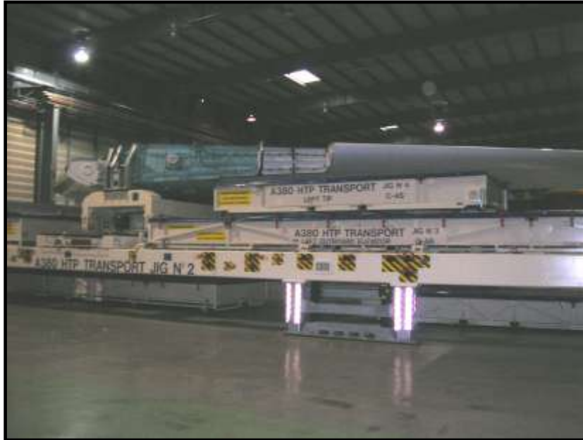
Estabilizador A380 antes del transporte para su entrega
