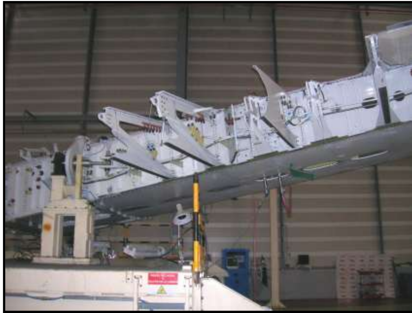
Visión del sistema hidráulico en el RS del HTP A380 en la Fase V
