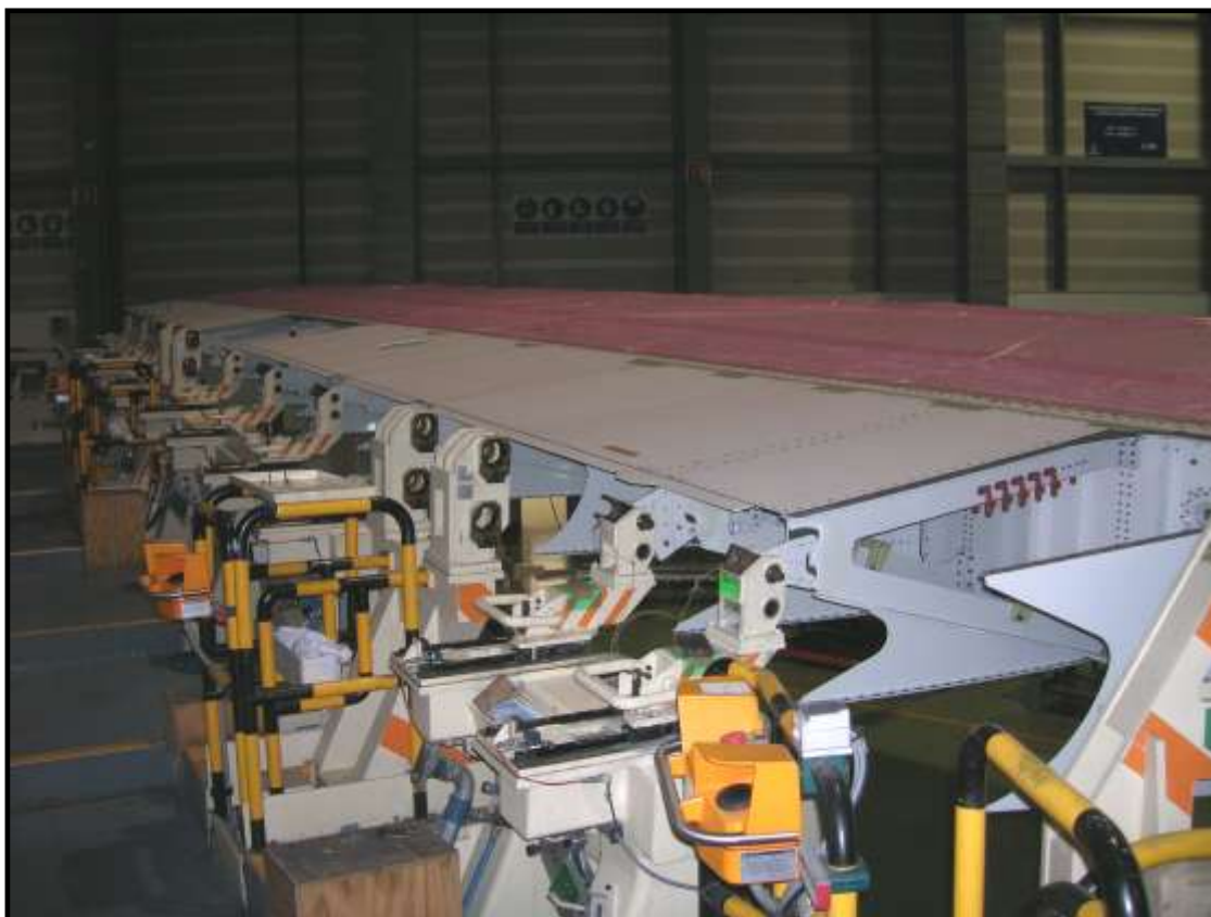
Instalación de componentes Superiores del BS en la Fase II
