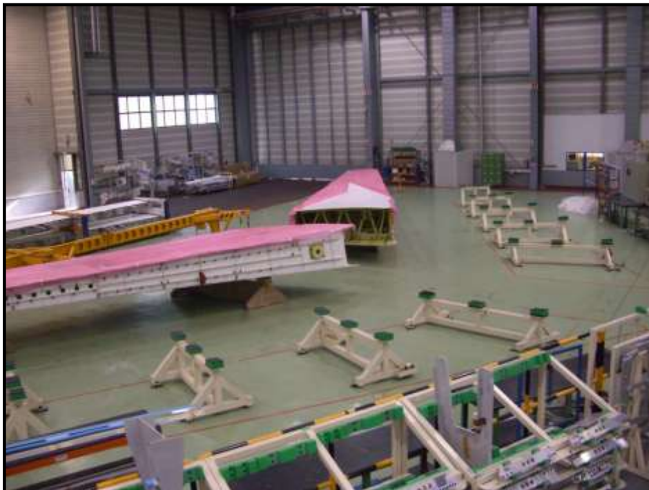
Vista real de la Fase I, antes de posicionamiento de los cajones laterales para su posterior tratamiento
