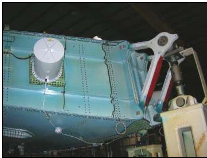
Visión del FF, Jack fitting o herraje en V y las bombas de combustible. Sellado y cubierto del protector de la zona de combustible.
