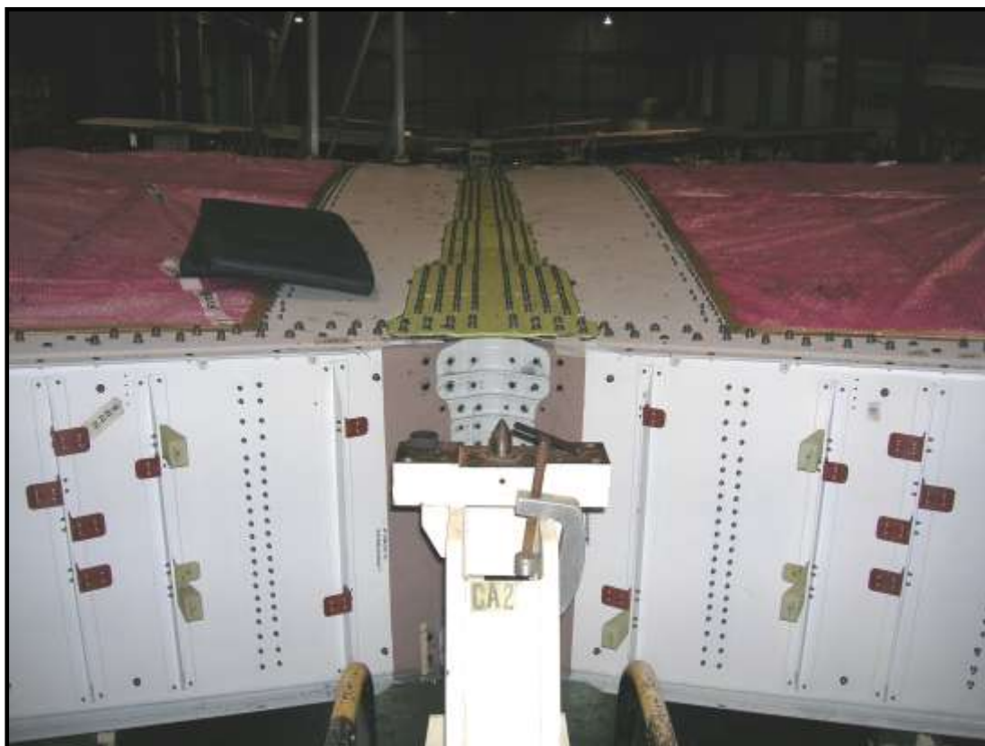
Taladrado de Integración de la zona central en la Fase II
