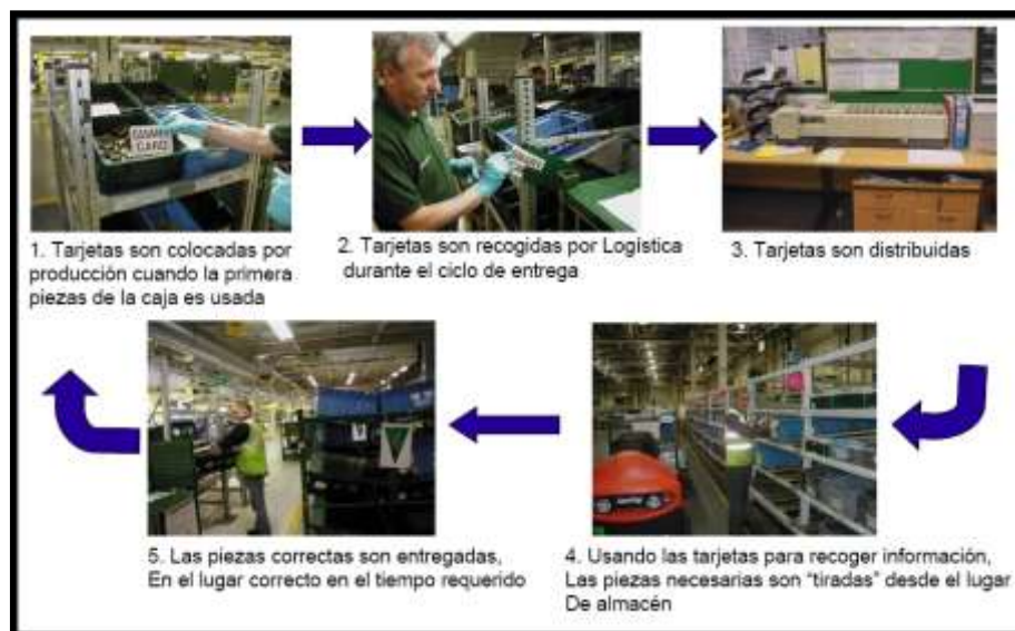
Ciclo kanban en el proceso de producción del HTP A380
