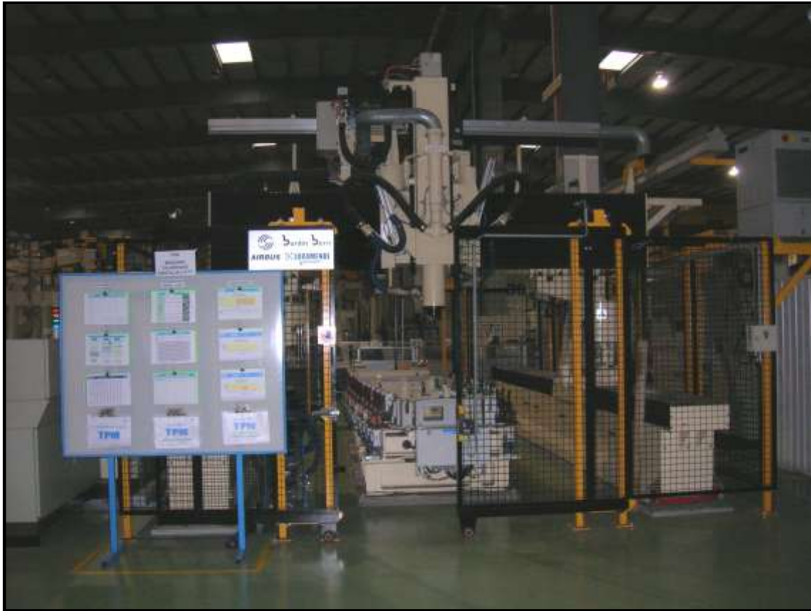
Taladrado Automático de la costilla 1 en la Fase II
