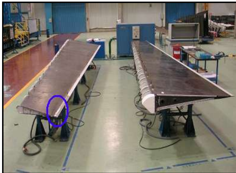
Figura 7.1.3.1.a. Representación del extremo final de acero inoxidable de los timones y de todo el resto del extremo de aluminio
