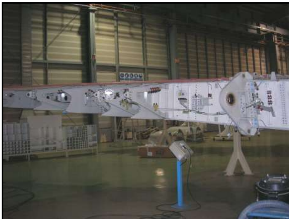
Instalación hidráulica en la Fase IV
