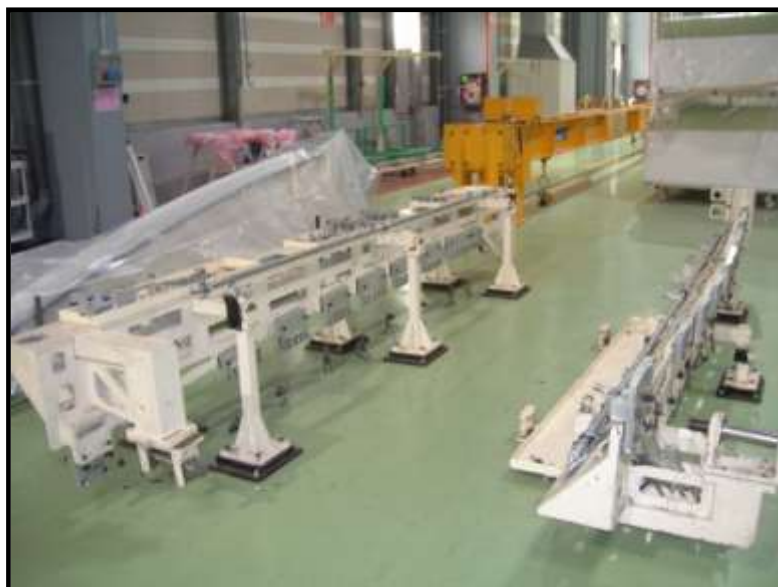
Situación en la Fase III, donde se realiza el montaje y el sellado de los soportes de las carenas karman
