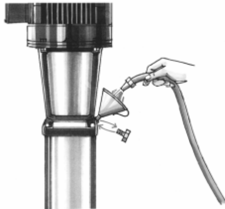
Figura 5. Detalle del cebado de la bomba.
