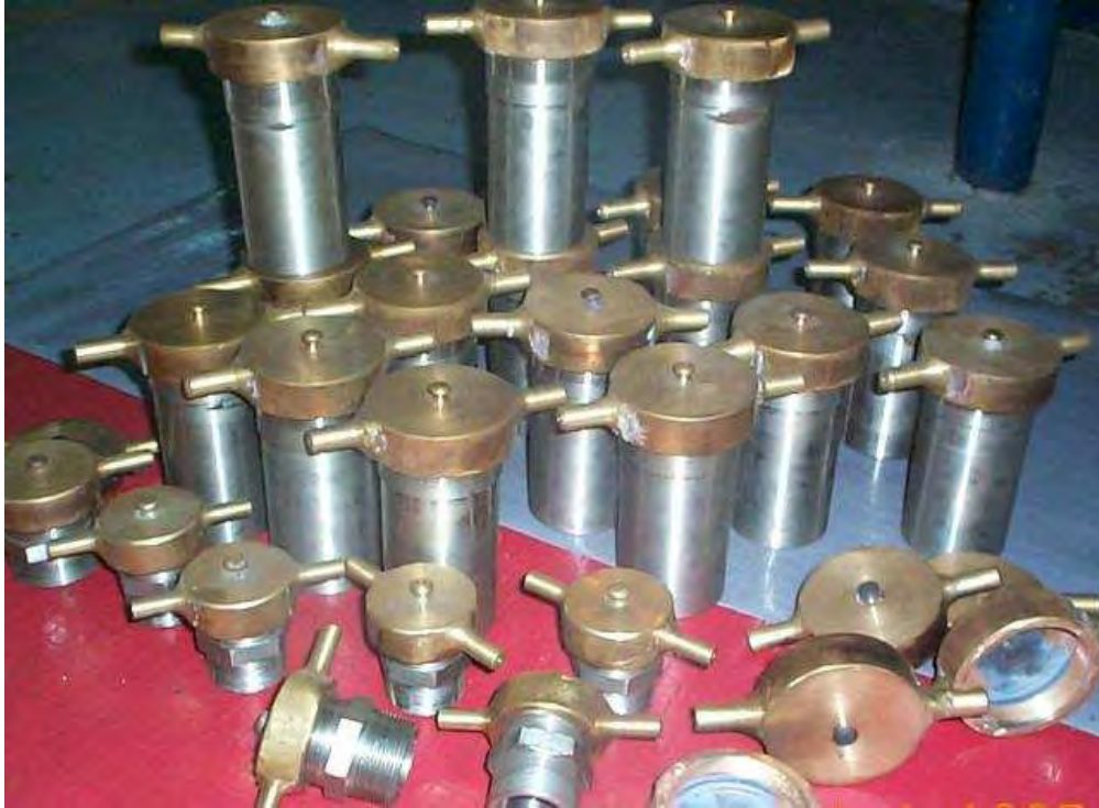
Figura 24. Tapas de las tuberías de sonda.
