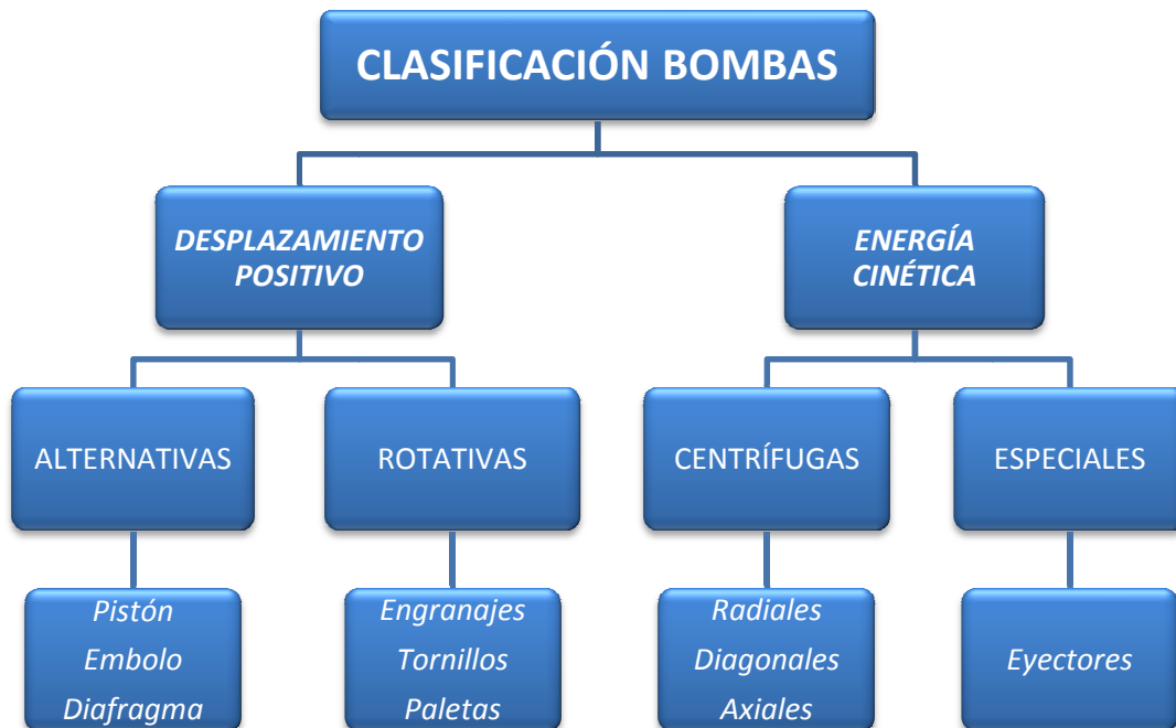
Figura 4. Clasificación de las bombas de uso más común en el sector naval.
