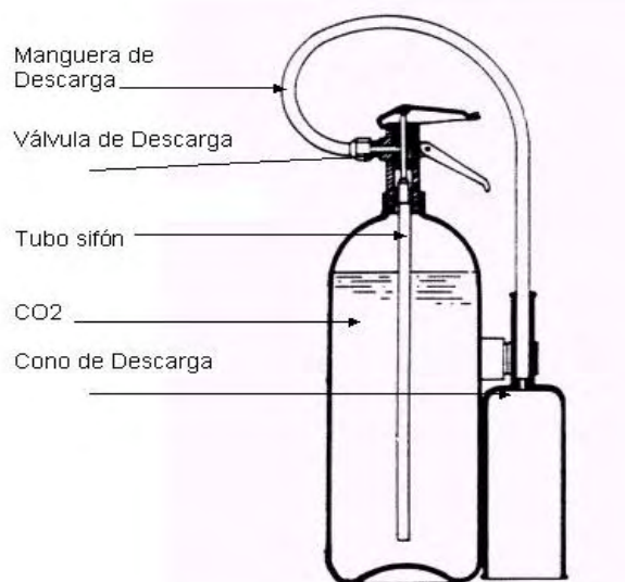
Fig. 6: Extintor de dióxido de carbono (CO 2 ).
