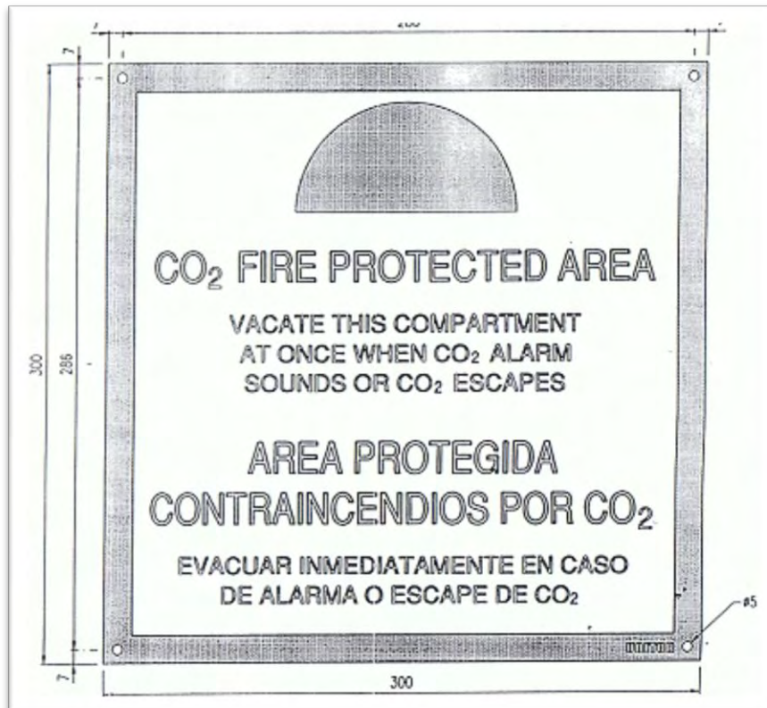
Fig. 11: Señal de advertencia en áreas protegidas por CO 2
