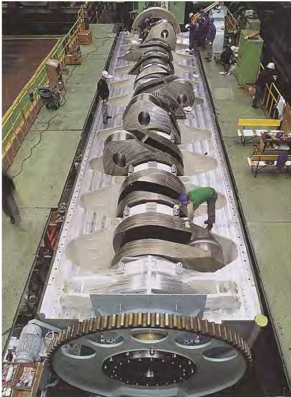
Ilustración 8 Cigüeñal montado en el Bloque motor
