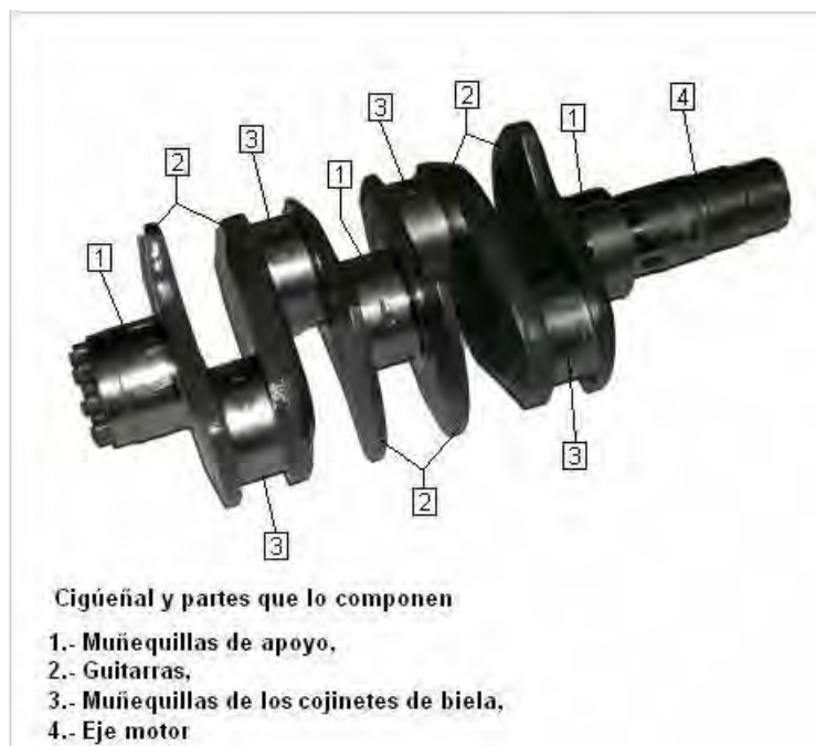
Ilustración 4 Partes del cigüeñal
