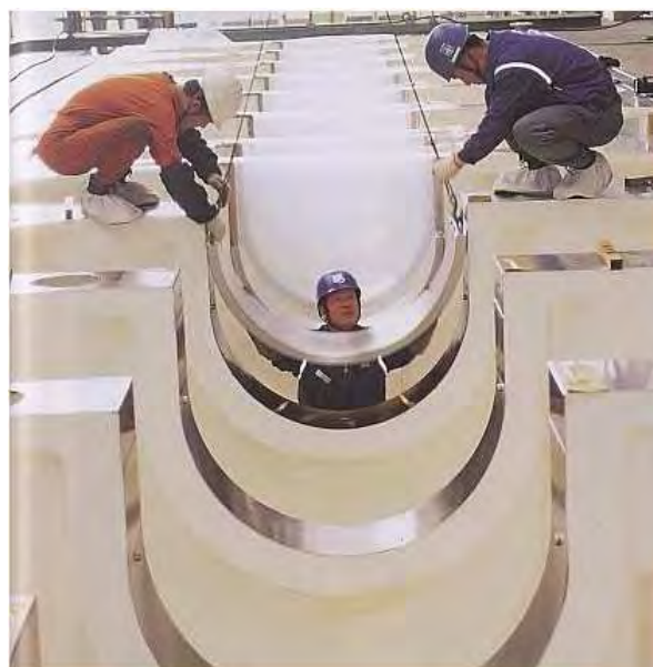
Ilustración 12 Recubriendo cojinetes de fricción
