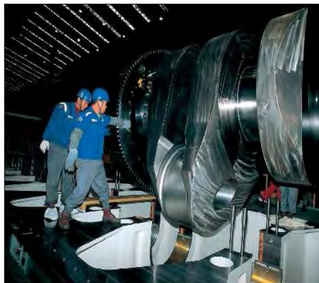
Ilustración 13 Ajuste cigüeñal a banco motor
