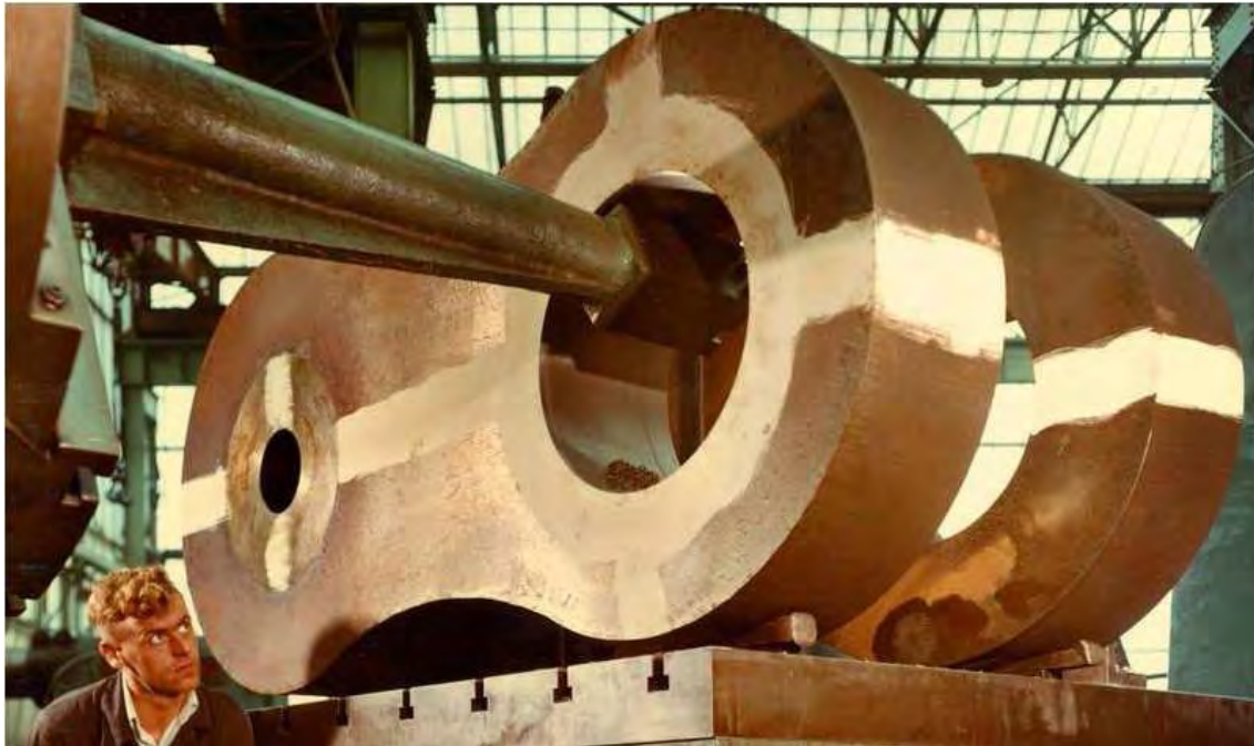
Ilustración 16 Mecanizado de guitarras
