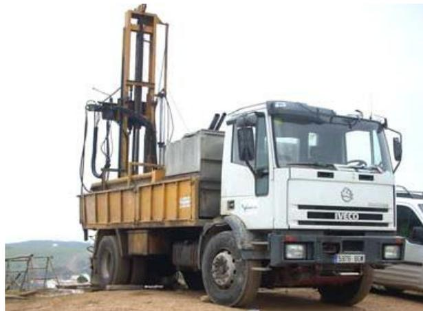
Las perforaciones se realizan con una sonda de avance hidráulico montada sobre camión o con motricidad autónoma (según las necesidades y características del estudio) dotada de castillete o torre de sondeo y bomba de lodos. El testigo reconocido se aloja en un tubo testigo hueco, en cuyo extremo inferior va enroscada una corona de vidia o diamante que va realizando la perforación.
