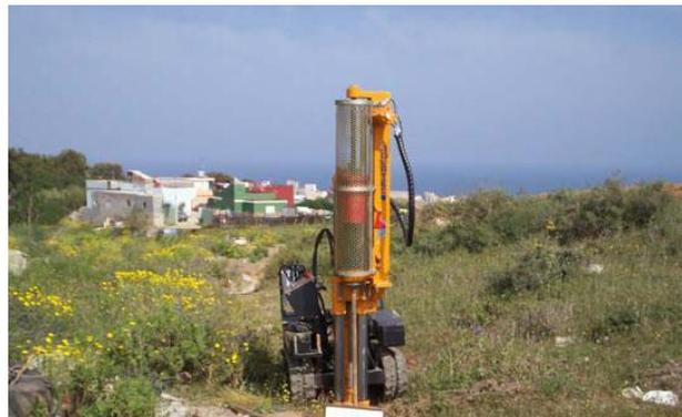
El equipo de penetración utilizado es del tipo DPSH, con las siguientes características:
