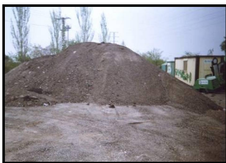
Figura 1-6. Restos de demolición de firmes para reutilizar como zahorra artificial.
