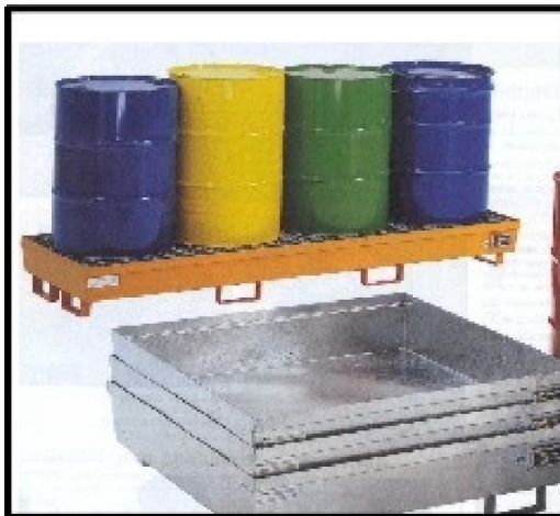
Figura 1-6. Almacenamiento de RP sobre cubetas colectoras de chapa de acero de 3 mm. La cubeta debe tener capacidad para recoger el volumen total de los líquidos almacenados. Si se almacenan sustancias diferentes, deben ser compatibles entre sí
