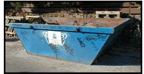
Figura 1-3. Ejemplo de volquetes para depósito de RCD en obras.
