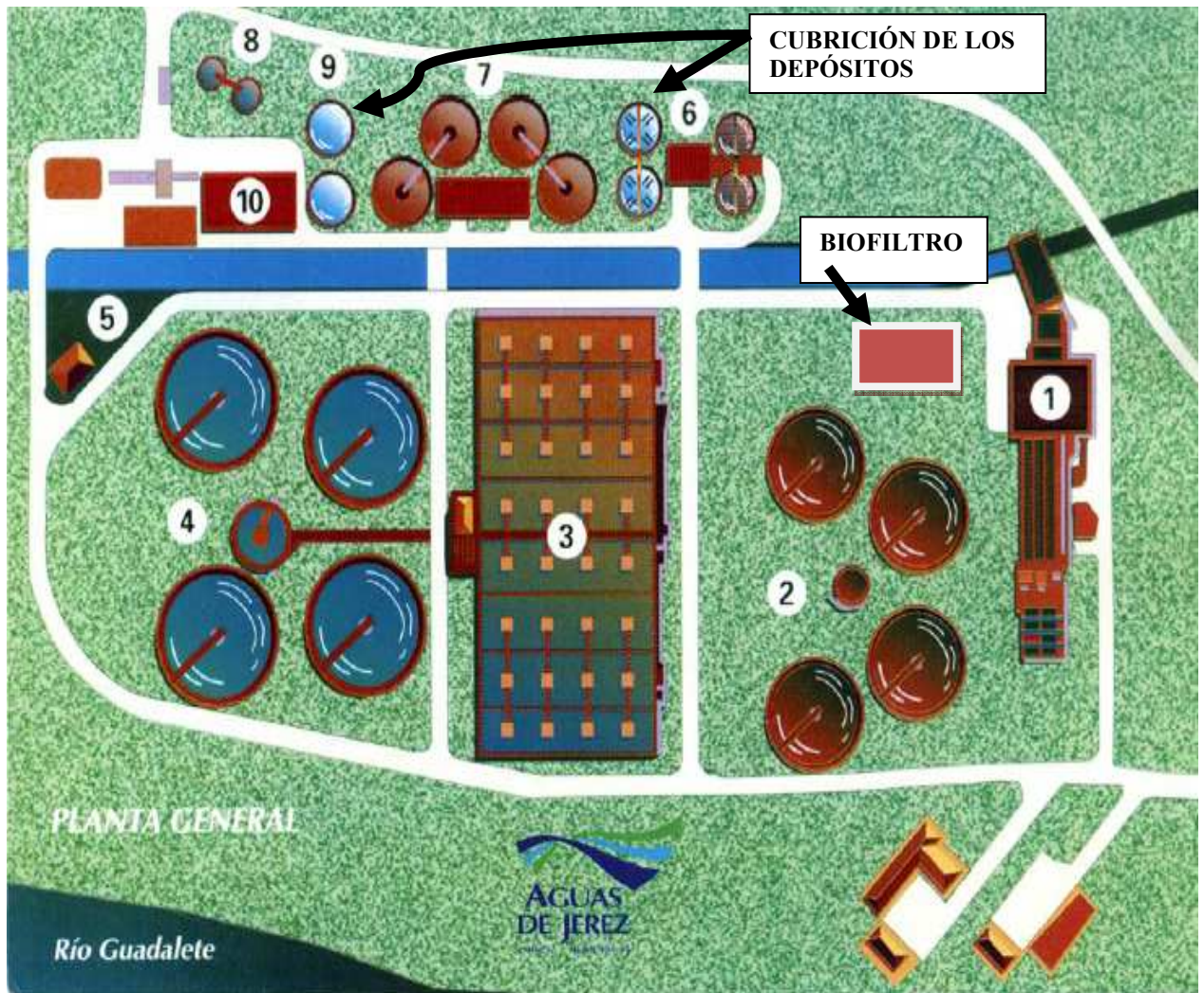
Figura 15: Planta EDAR "Guadalete".
