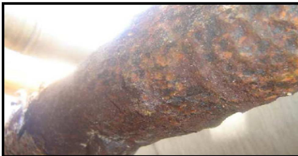
Figura. A2.18. Efectos de la corrosión bajo aislamiento. (CEPSA)
