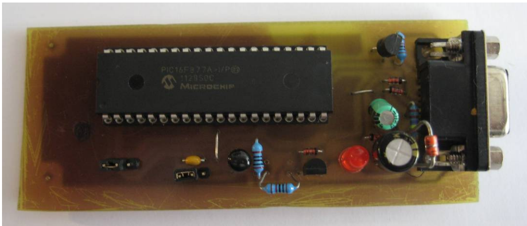
Ilustración 2.5: Programador MULTIPIC PROGRAMMER 5Ver.2 montado para este proyecto
