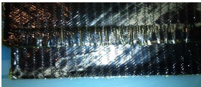
Fig. 143 Ondulaciones producidas por reacciones exotérmicas en el curado
