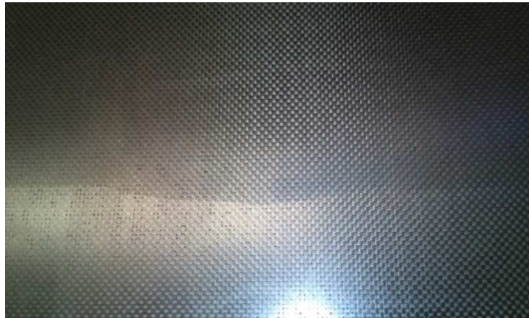
Fig.187 Aparición de zonas sin imprimir (franja inferior al frente de imprimación)
