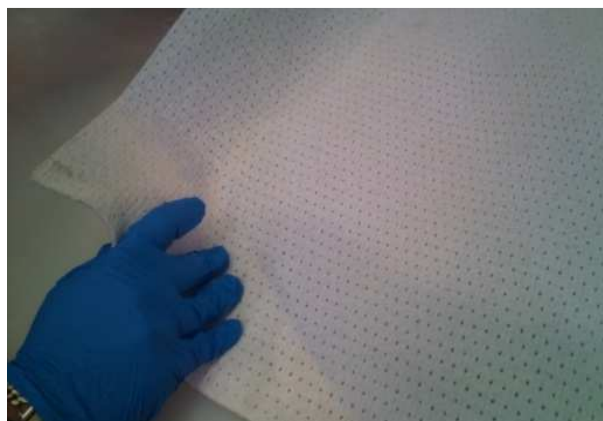
Fig.112 Espuma de poliéster para la retención de resina en los procesos
