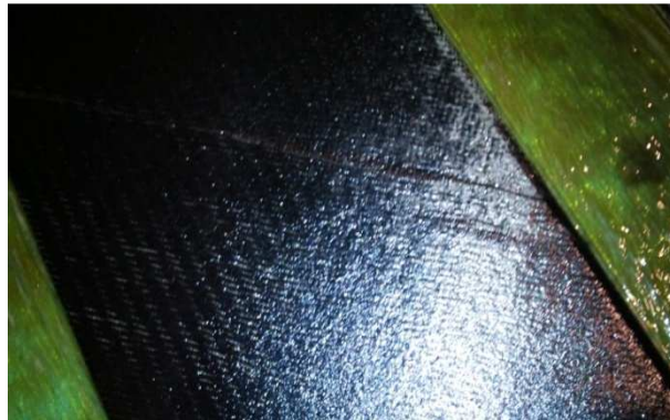
Fig.195 Acabado rugoso dado por el film separador
