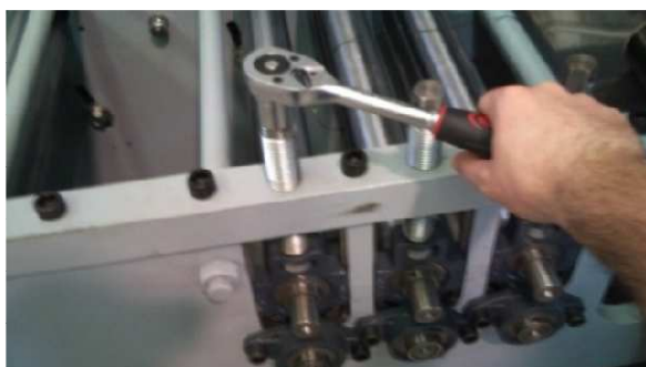
Fig.164 Variación de distancia entre rodillos
