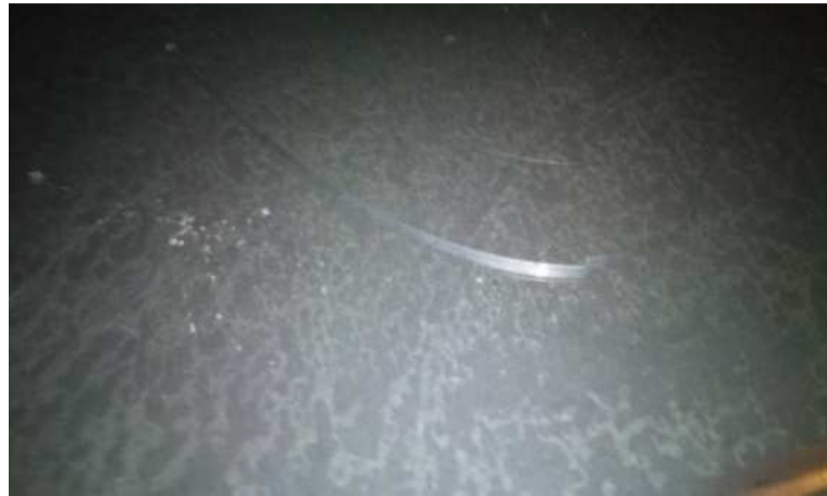
Fig.186 Imperfección sobre el molde inferior
