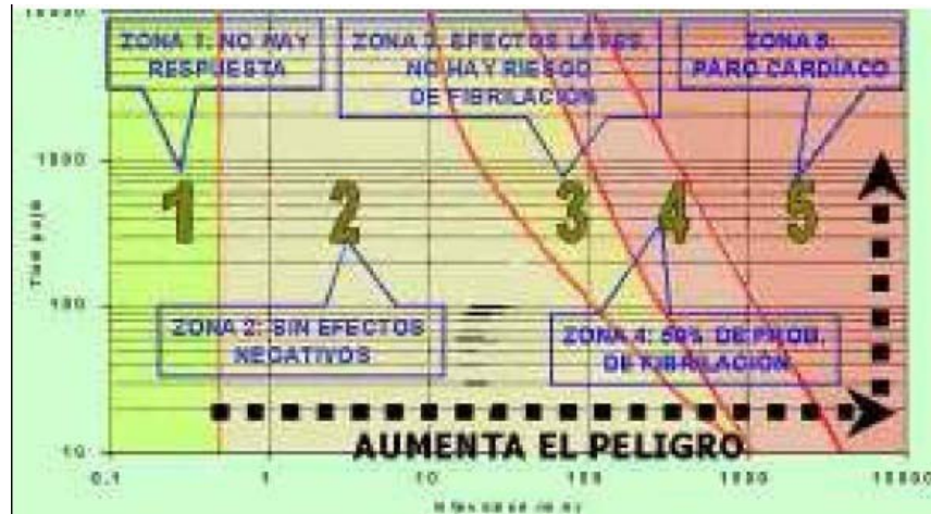
Figura 93. Zonas de riesgo eléctrico
