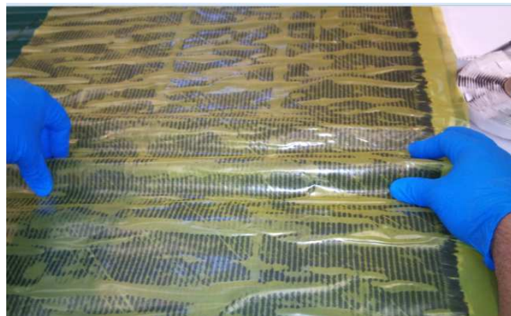
Fig.147 Laminado del molde ondulado con fibra de carbono desde el centro hacia los bordes del útil
