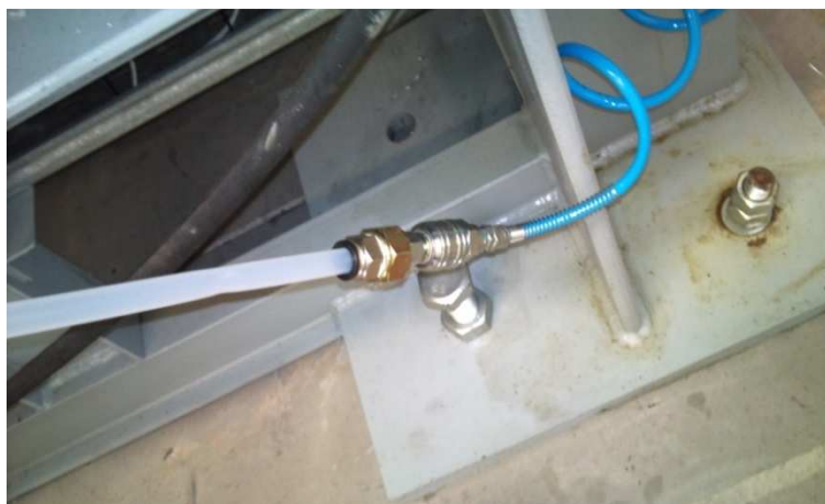
Fig. 199 Conexión del tubo al sistema de vacío.
