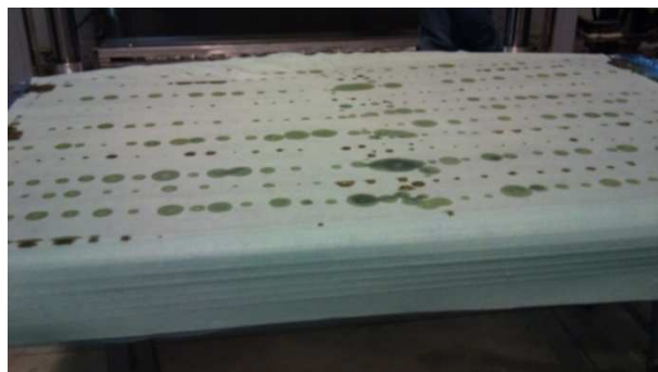
Fig.196 Absorción de la resina por parte de la manta
