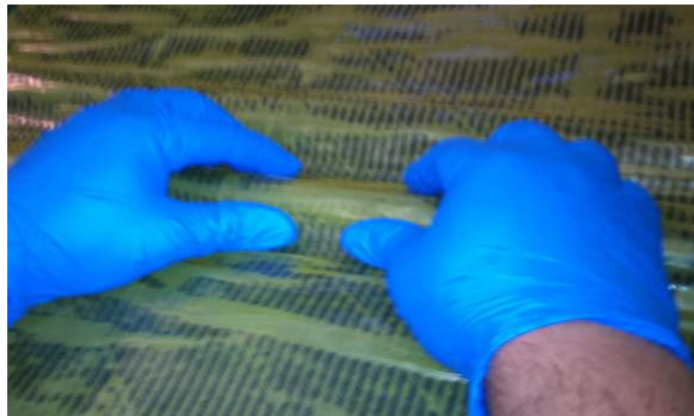
Fig.146 Se debe ejercer presión sobre valles y crestas para adaptar el prepreg al molde.
