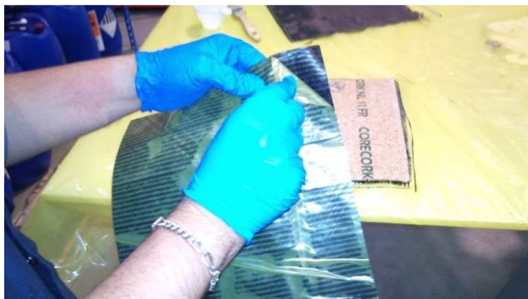
Fig. 129 Se precisara remover el plástico protector para realizar el laminado.
