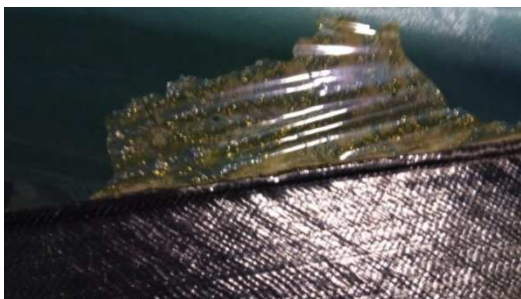
Fig. 142 Curado de material con un porcentaje mayor de resina en su superficie
