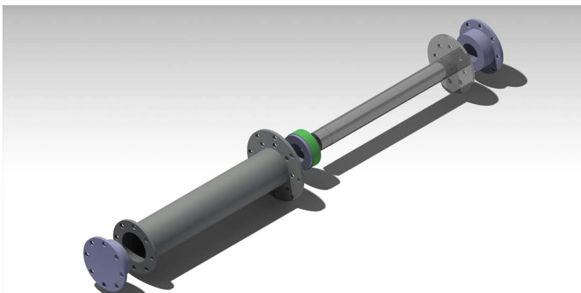
Figura 23. Vista del montaje de los distintos elementos del cilindro hidráulico
