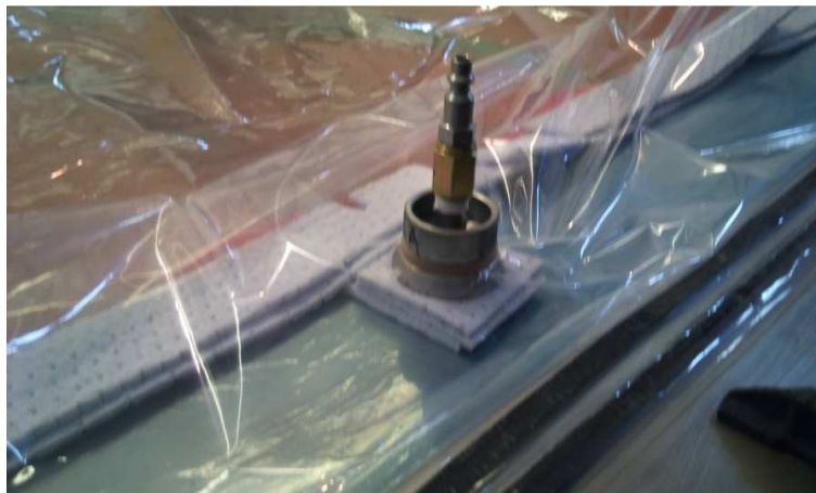
Fig.200 Conector para vacío al cual se acopla el circuito neumático
