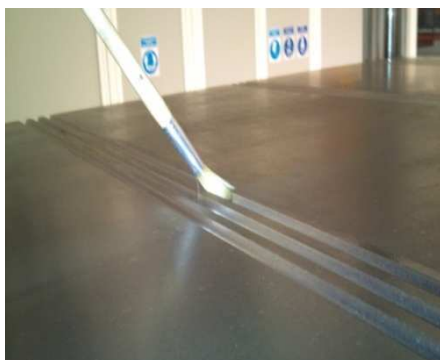
Fig.: 152 Aplicación de líquido desmoldante tanto en el mecanizado por donde pasa el tubo espiral (izquierda) como en la superficie donde se depositarán las telas (derecha).
