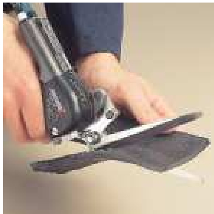
Fig.193 Tijera neumática para el corte de telas de carbono y vidrio
