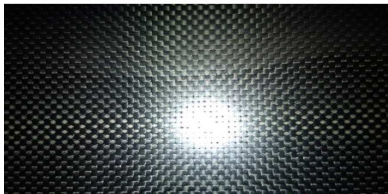
Fig.194 Acabado liso dado por líquido desmoldante
