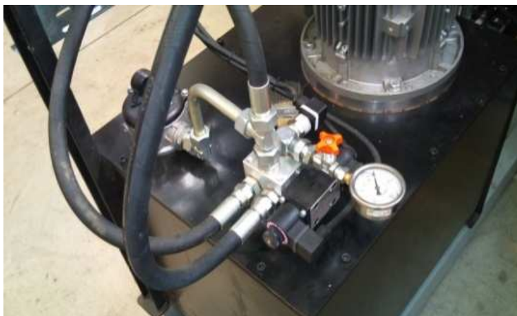
Fig.174 Válvula direccional con solenoides instalada
