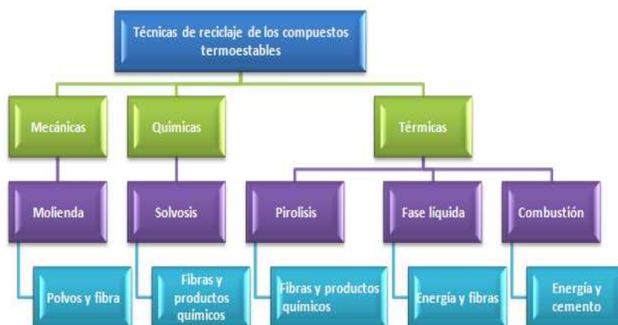
Fig.167 Esquema de los distintas técnicas de reciclaje de los compuestos termoestables
