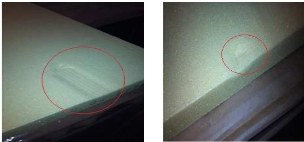
Fig.183 Imperfecciones en la superficie de la espuma de PVC.
