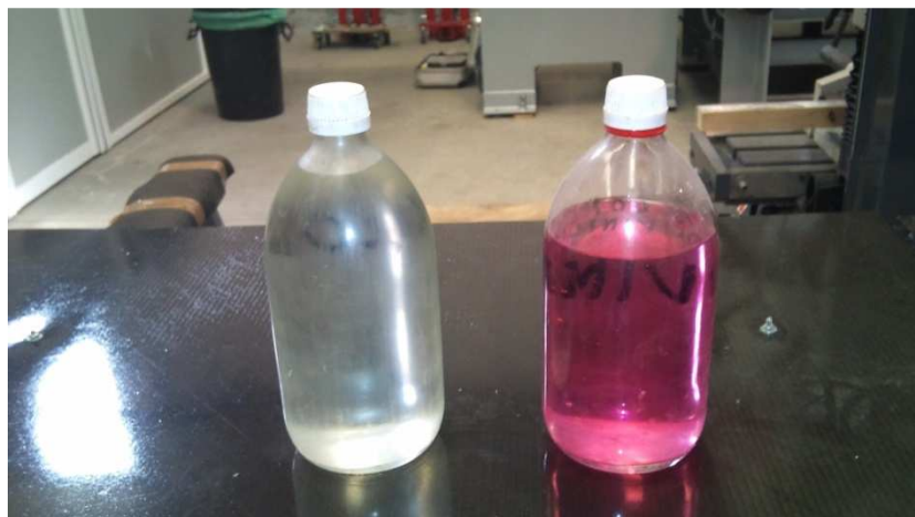
Fig.109 Marbocote (líquido amarillo) y alcohol polivinílico (líquido rosáceo)
