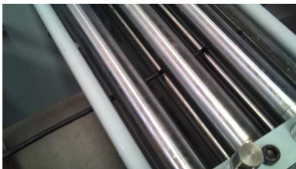
Fig. 165 Salida del perfil a través del sistema de rodillos
