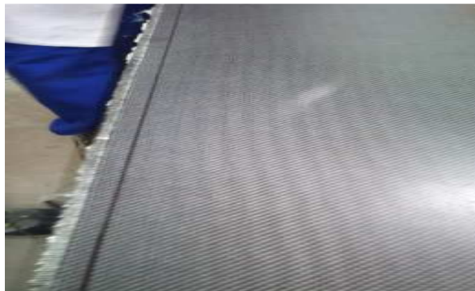
Fig.137 Filos de la estructura sándwich marcados para realizar el recantado
