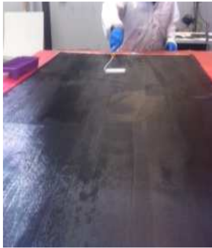
Fig. 130 Impregnado de fibra de carbono seca
