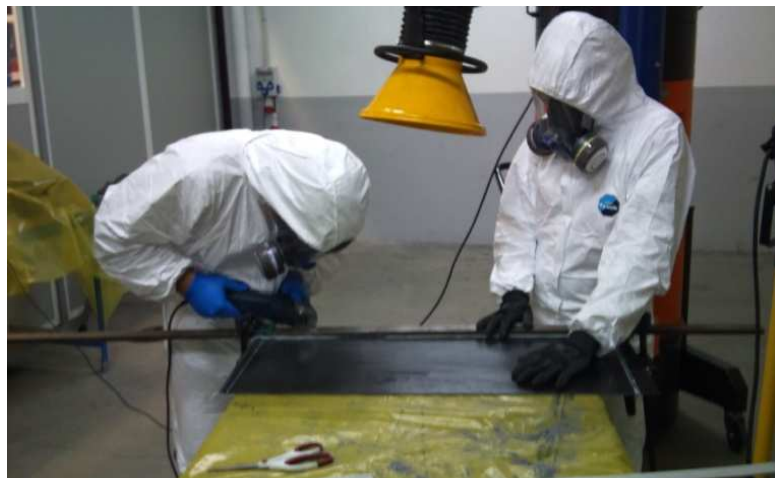
Fig.170 Uso de aspiración en sala de recantado
