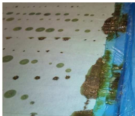
Fig.198 Excesos de resina por elección errónea del film microperforado
