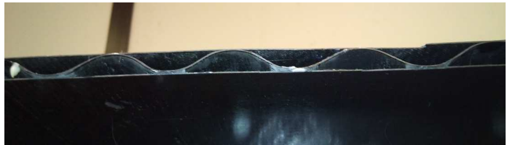
Fig.144 Plancha ondulada entre láminas de fibra de carbono
