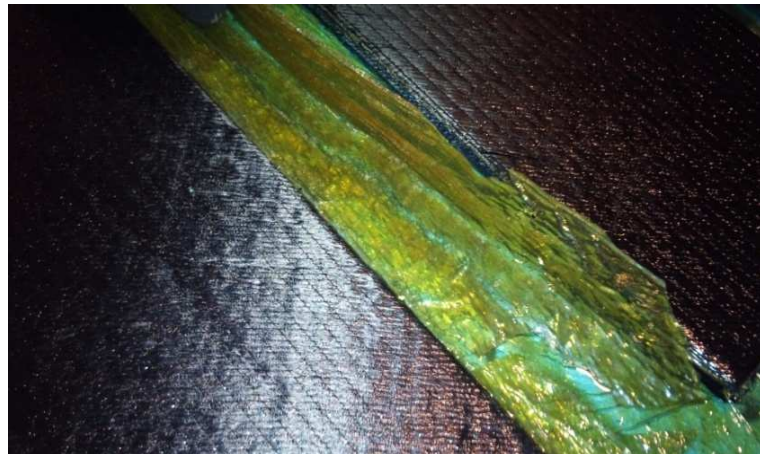
Fg.184 Aparición de filos de resina en los extremos de las estructuras sándwich
