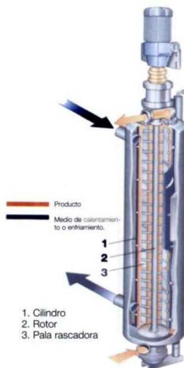
Figura 3.9. Partes del evaporador de un intercambiador de calor de superficie rascada
