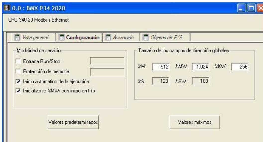
Fig. 5.3. Parámetros de configuración de la CPU del PLC
