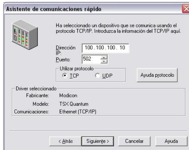
Fig. 6.3. "Configuración de la dirección IP y puerto"
