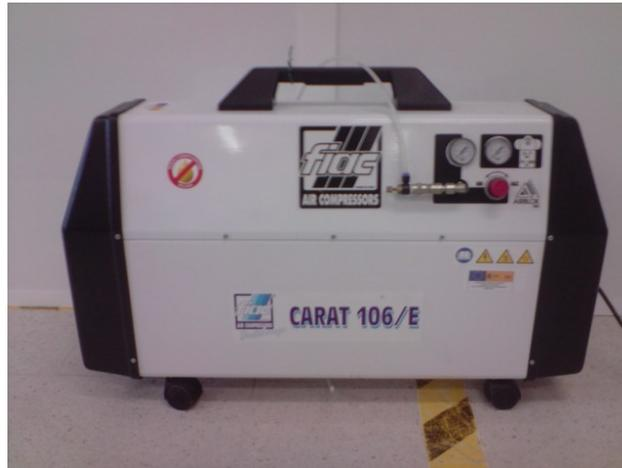
Fig. 1.4. Compresor de aire.
