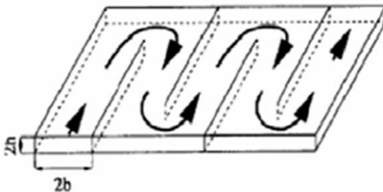
**Figura 38** – Posible circuito para el fluido caloportador al pasar por el interior del
